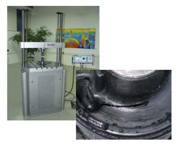
**P**assend zur *NewLine*-Serie gibt es nun auch die SincoTec-Hydraulik-Lastrahmen in Lastbereichen von 10 kN bis 250 kN bzw. auf Anfrage auch für höhere Lasten.
