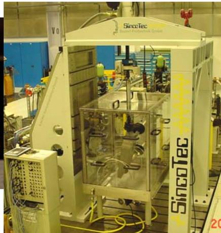
Zusammen mit der Firma DaimlerChrysler in Sindelfingen hat die SincoTec einen vieraxialen Prüfstand entwickelt, um Halbachsen unter Betriebsbeanspruchungen mit Korrosion prüfen zu können.
